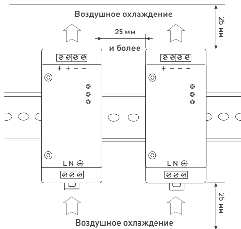
Рис. 1. Рекомендуемое размещение источника питания и обеспечение циркуляции воздуха.
