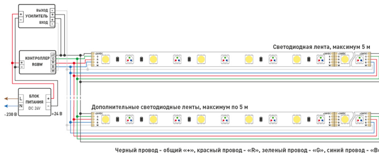
Схема 2. Подключение нескольких светодиодных лент с двух сторон.
